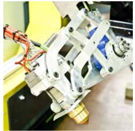
Taglio a cianfrino automatico con plasma Automatic Bevel cutting with plasma
