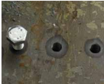
Taglio a cianfrino con ossitaglio Bevel cutting with flame
