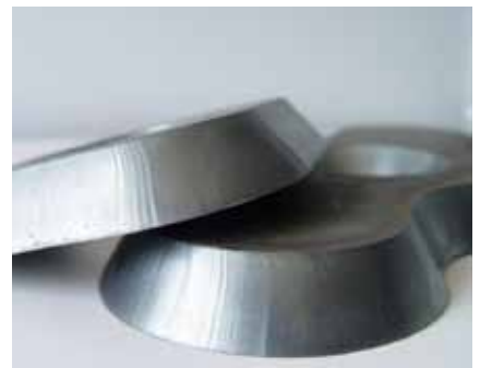
Taglio a cianfrino con ossitaglio Bevel cutting with flame
