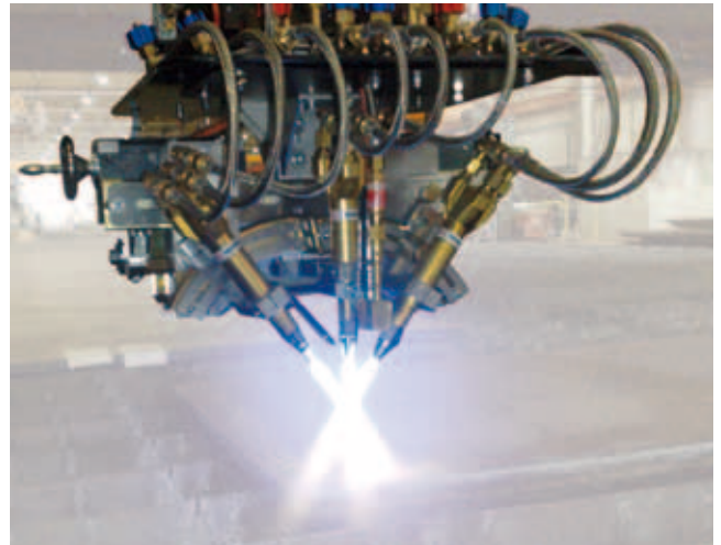
Taglio a cianfrino con ossitaglio Bevel cutting with flame
