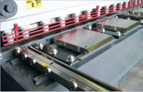
Гидравлическая система с независимыми прижимными цилиндрами обеспечивает постоянное усилие прижима, предотвращая смещение листа во время резания. Переднее защитное ограждение обеспечивает безопасность в работе.
