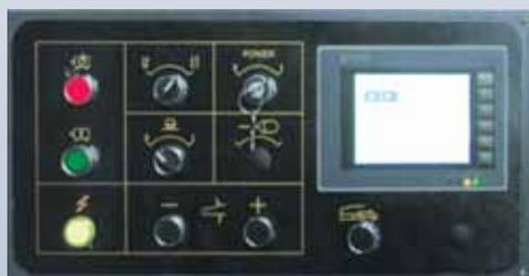
Переключатели и кнопки централизованного управления, **контроллер с сенсорным экраном**, обеспечивают эффективную и удобную работу. Электрогидравлическое регулирование угла реза  $0,5^{\circ}$ – $2,5^{\circ}$ . Отход заднего упора и счетчик ходов программируются посредством сенсорного экрана контроллера.
