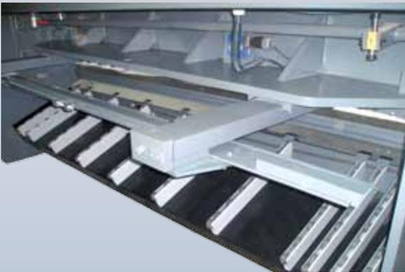
Перемещение заднего упора по оси X производится с помощью двигателя переменного тока с фирменным преобразователем, управляется контроллером с сенсорным экраном.
