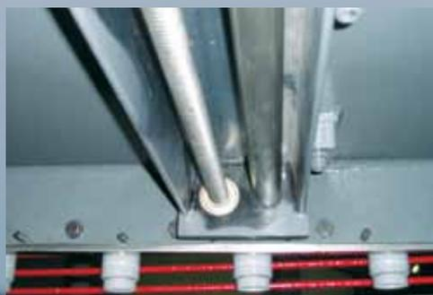
**Задний упор управляется сдвоенной ШВП посредством привода**, обеспечивает точность, надежность и не требует особого технического обслуживания, регулируется контроллером с точностью позиционирования  $0,1$  мм.
