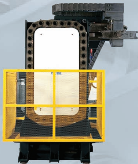
Система автоматической смены инструмента Магазин рассчитан на 40 (60; 90; 120 опция инстру- ментов. Конус BT-50 или DIN
