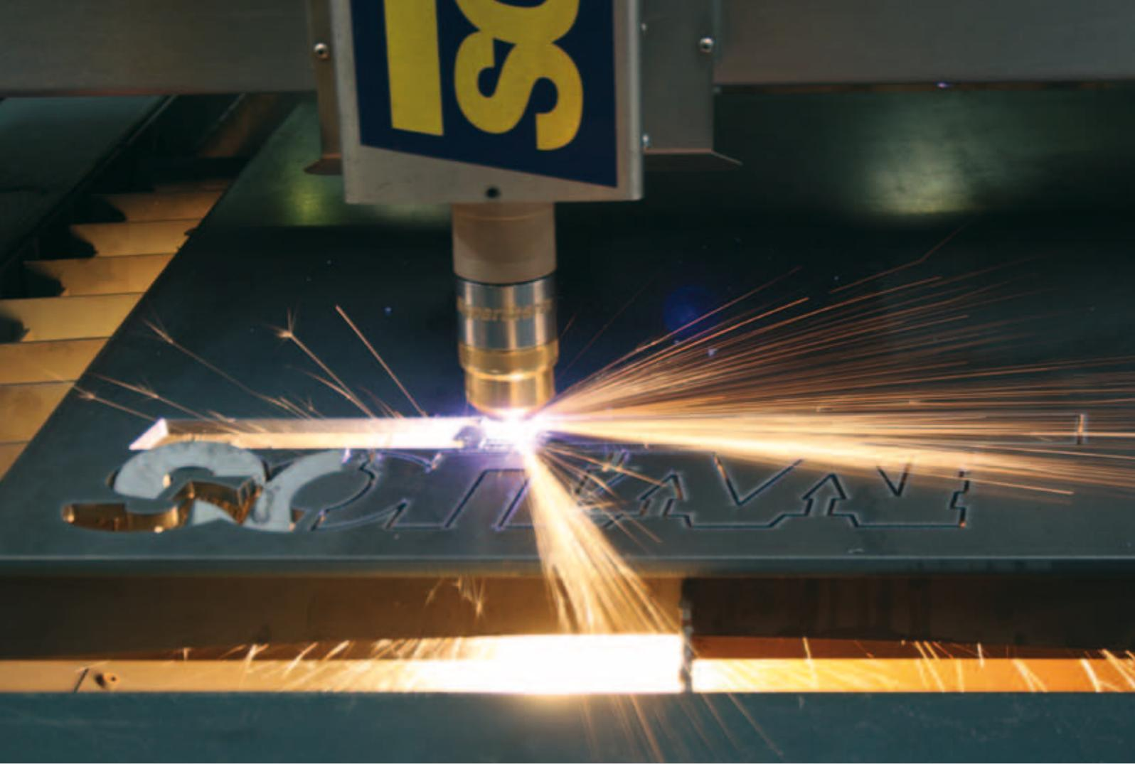
ПЛАЗМЕННАЯ РЕЗКА | *PLASMA CUTTING*
