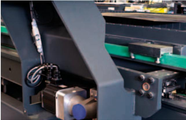
Двойной продольный привод портала содержит бесщёточные моторы и планетарную коробку передач. Трансмиссия осуществляется при помощи механизма реечной передачи с коробкой передач и устройством автоматической компенсации прогиба.
